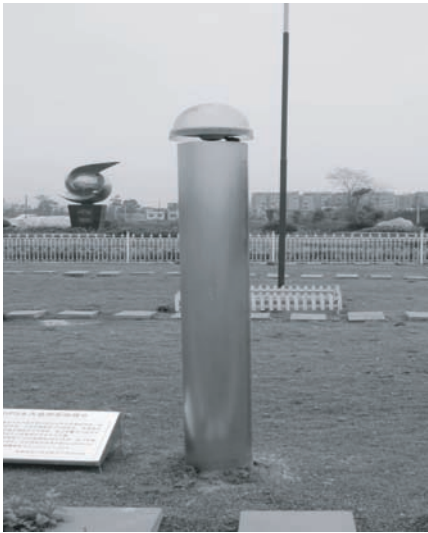
图 3 成都信息工程学院 GPS 外场接收天线 Fig. 3 GPS receiving antenna in Chengdu University of Information Technology
