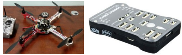
图2 四旋翼无人机结构和飞控硬件板
