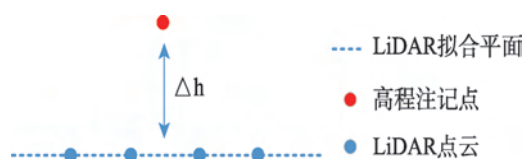
图2 LiDAR点云拟合局部高程示意
