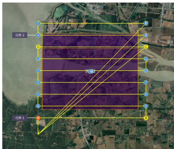
图8 洪泽湖口无人机作业区域航拍路径
